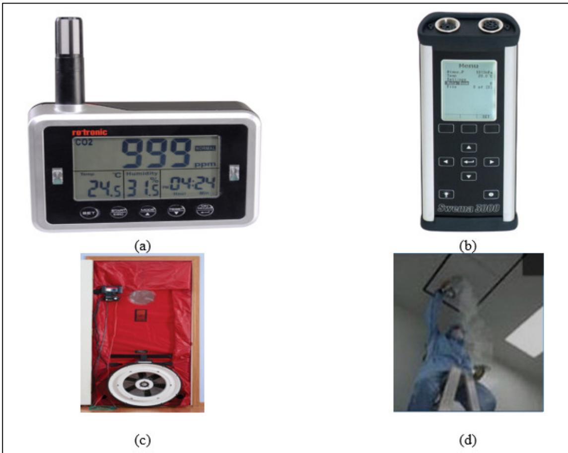
Figure 1. Example device (a) Rotronic CL11 device, (b) Swema3000, (c) Blower door, (d) Smoke
